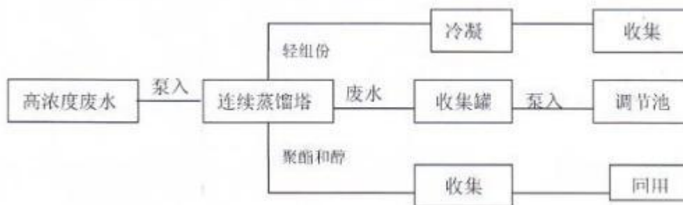
图 4.1-2 精馏工段污水处理工艺流程图
